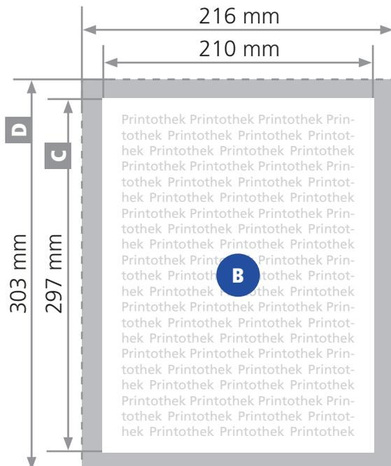
**\*Beschnitt** = Der Beschnitt (a) fällt beim Schneiden auf das Endformat weg und vermeidet dünne weiße Kanten bei geringfügigen Toleranzen.
